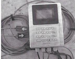
超声波流量计用于计量流经管道的水量的计量器具。该流量计通常由一对或几对超声换能器, 信号电缆和测量主机所构成。超声波流量计是利用超声波在流动液体中顺流与逆流传播速度差与流速成正比的关系作为测量原理。因此只要测得超声波在流动液体中的传播速度差以求得流体的流速, 就可根据圆管的横截面积获得流量与累积流量。
