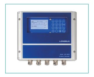
LRF-3300S是一款时差式超声波流量计。时差式超声波流量测量是通过测量上下游传输时差从而获得管道内流速一种测量方式,其优势主要在于可以在不破管,不停水的情况下,通过安装外夹式传感器测量上下游传输信号的发射接受时间差,从而获得准确的流量数据。
