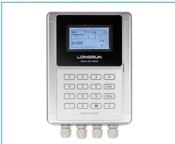
LRF-3000S是一款时差式超声波流量计。时差式超声波流量测量是通过测量上下游传输时差从而获得管道内流速一种测量方式，其优势主要在于可以在不破管，不停水的情况下，通过安装插入式传感器测量上下游传输信号的发射接收时间差的从而获得准确的流量数据。
